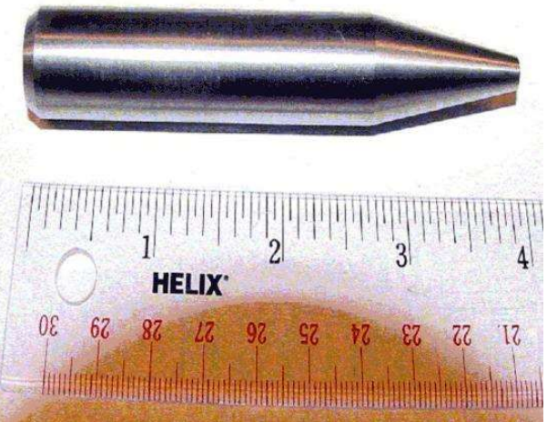
Urankern eines panzerbrechenden DU-Geschosses
