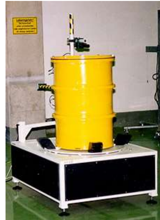
Messanlage zur Dosisleistungsmessung an 200 / 400 l-Fässern
